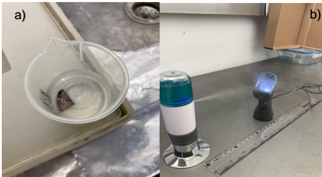
Figura 1 a) obtención de silicio poroso por electroanodización y b) depósito de película delgada de ftalocianina de erbio sobre sustrato de silicio poroso.
